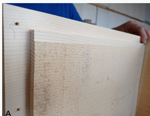
A. Prendere la schiena (1) e posizionare la fresatura per i distanziatori verso l'alto
